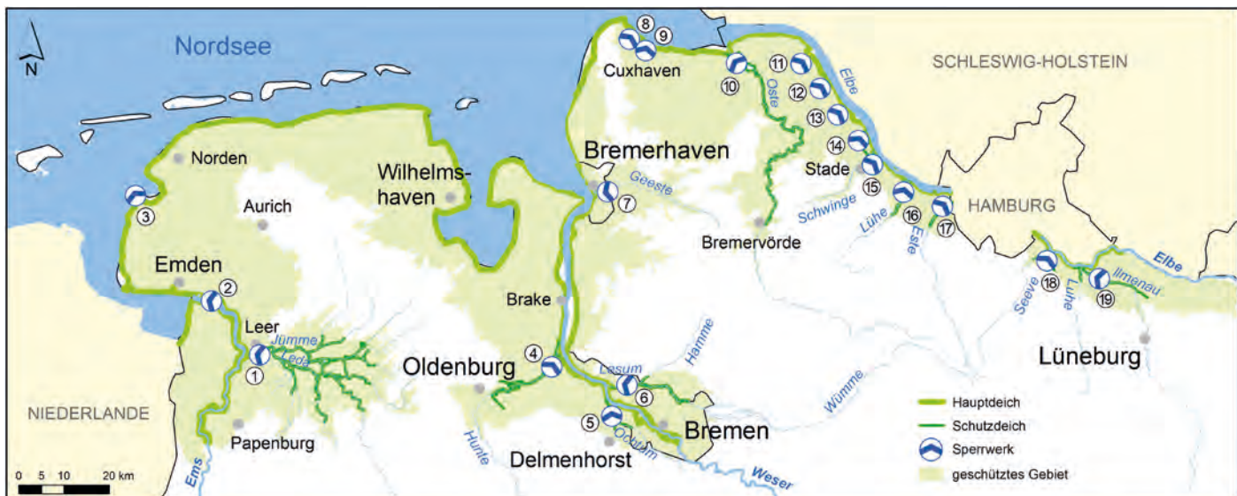
Abb. 4-1: Lage der Deichlinien und Sperrwerke (1) Leda, (2) Ems, (3) Leysiel, (4) Hunte, (5) Ochtum, (6) Lesum, (7) Geeste, (8 und 9) Cuxhaven, (10) Oste, (11) Freiburg, (12) Wischhafen), (13) Ruthenstrom, (14) Abbenfleth, (15) Schwinge, (16) Lühe, (17) Este, (18) Seevesiel, (19) Ilmenau
