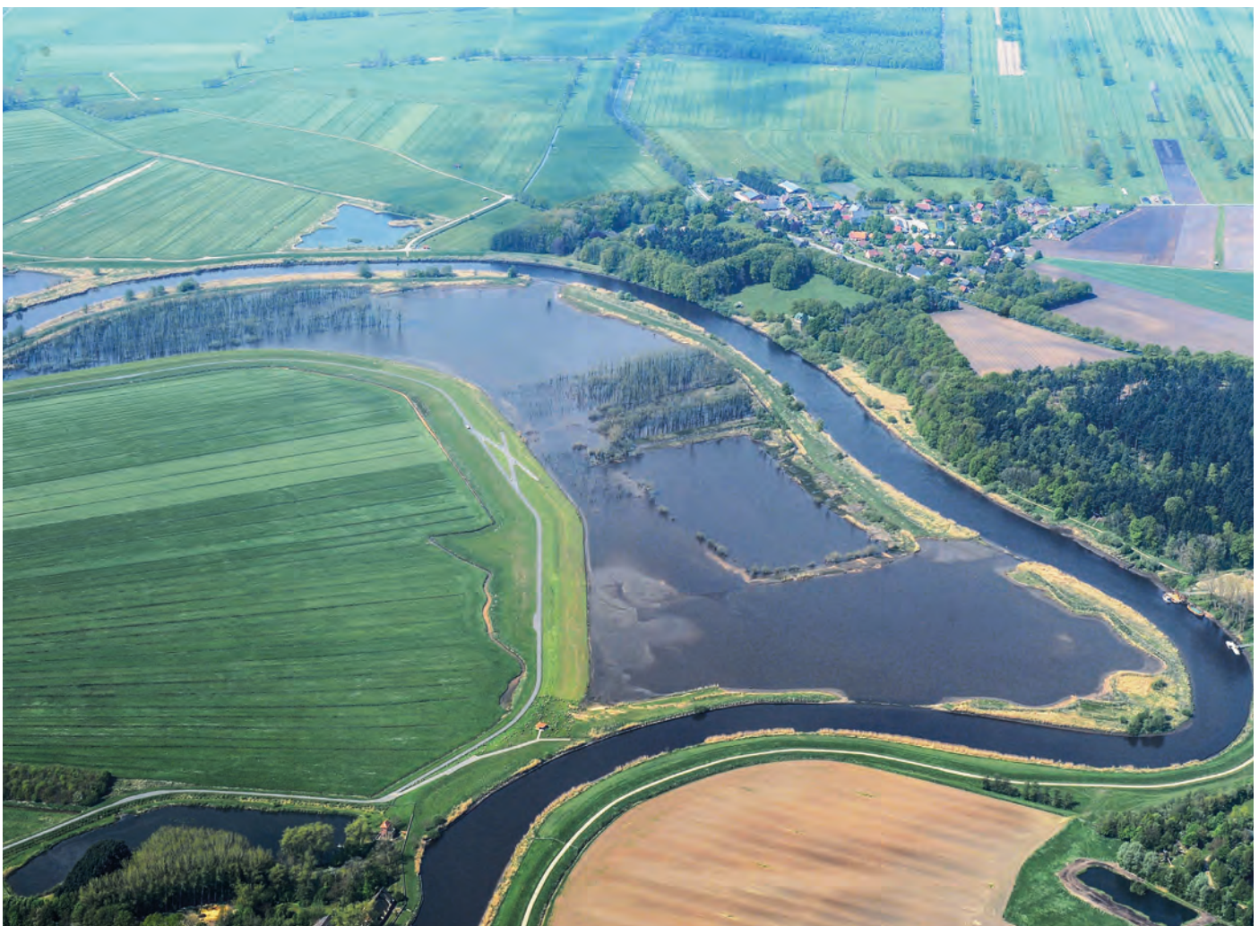
Abb. 6-1: Deichrückverlegung an der Oste
