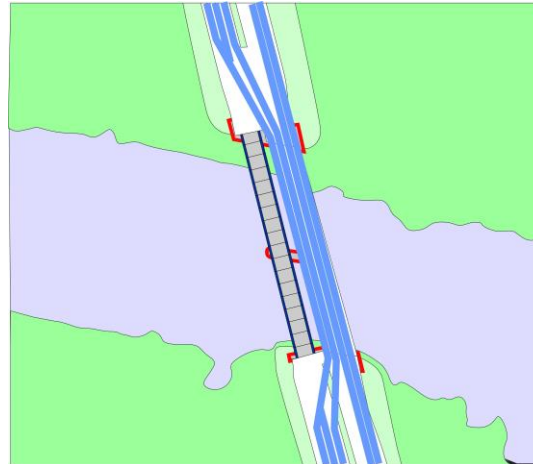
Variante 2: Einsatz einer System- Behelfsbrücke (SS80)
