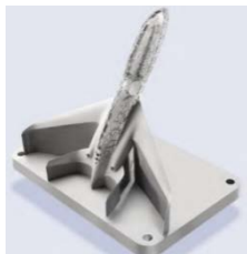
Airbus Concept Plane: hergestellt durch Laserschmelzen von Titanpulver
