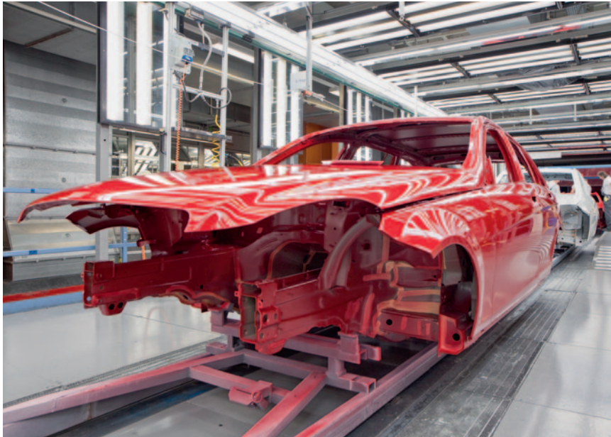
Die sogenannte weiße Platte: In diesem Bereich der Produktion findet die Endkontrolle der Lackierung einer Karosserie statt.
